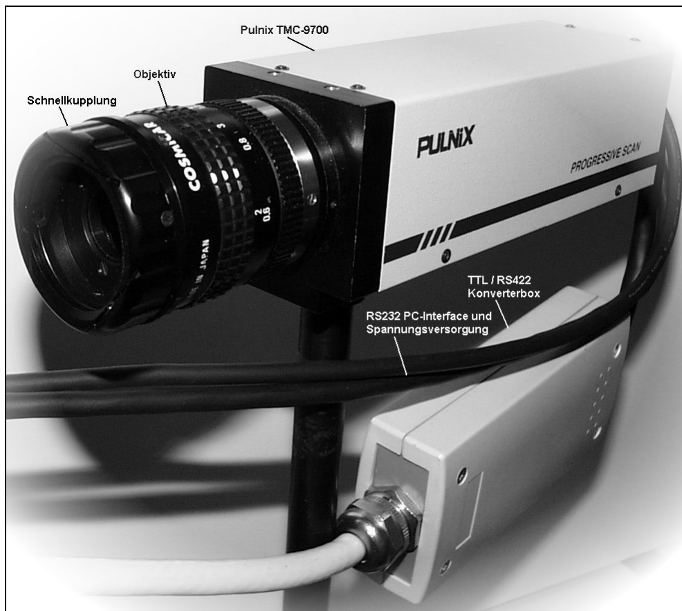
Bild 4.8: Farbkamera Pulnix TMC 9700 (betriebsbereit)
