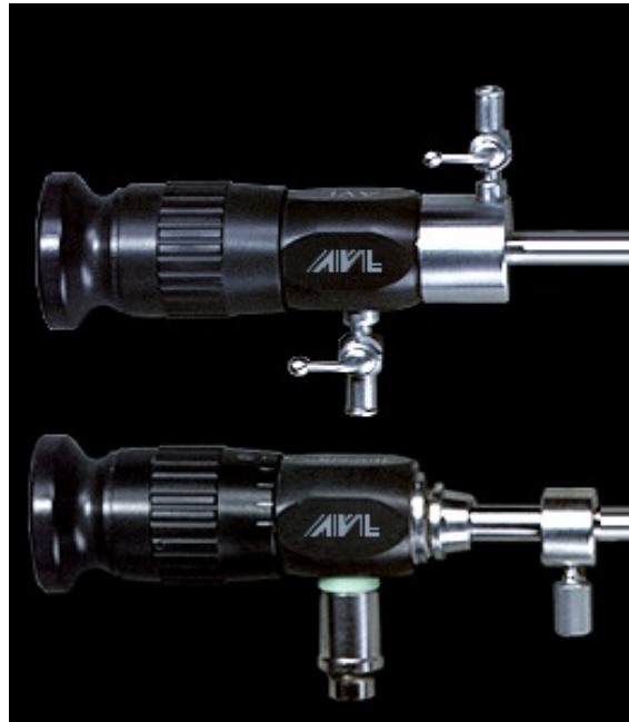
Bild 4.5: Gekühltes Endoskop (o) und Endoskop mit integriertem Lichtleiter (u)
