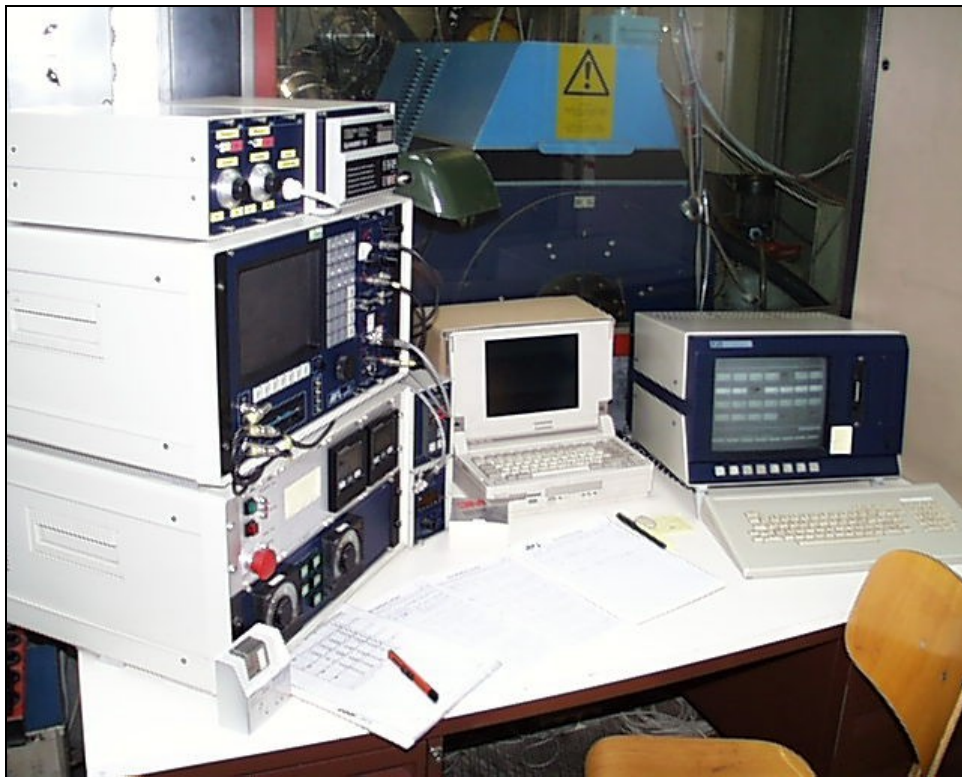
Farbtafel B1: Indiziergerät und Steuerpult am Motorprüfstand
